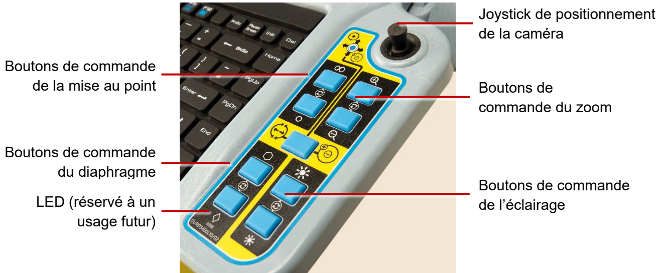
Fig. 6-16 Joystick de droite et boutons de commande de la caméra et de l'éclairage
