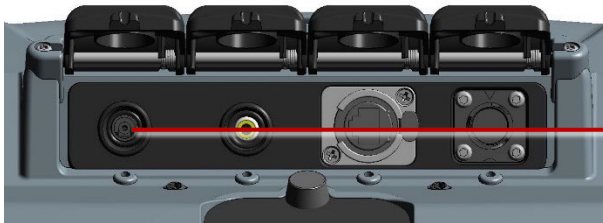
Fig. 4-32: Prise d'alimentation (1) sur le panneau de connexion principal
