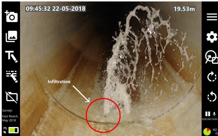
Fig. 6-32: Exemple d'affichage à l'écran avant de prendre une photo.
