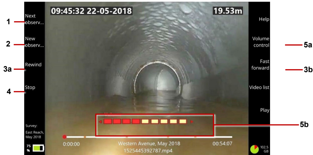
Fig. 6-31: Écran de lecture vidéo. 1 Bouton Observation suivante. 2 Bouton Nouvelle observation. 3a, 3b Bouton Retour en arrière et Avance rapide. 4 Bouton Stop. 5a Bouton de contrôle du volume. 5b Niveau de volume. Utilisez les touches fléchées ⇐ ⇨ pour régler le volume.
