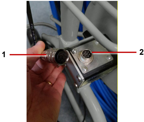
Fig. 4-23: Le câble de raccordement (1) se connecte au touret du jonc de poussée (2)
