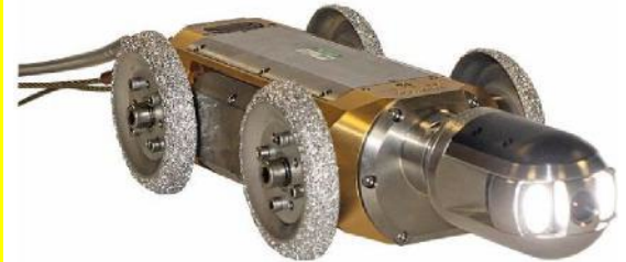
Fig. 4-3: Roues abrasives montées sur un P556
