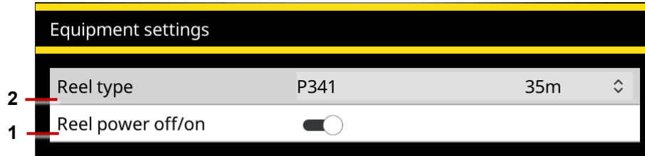
Fig. 6-19 Menu Paramètres de l'équipement pour 1 le Type de bobine. 2 Alimentation électrique du touret Off / On (en position On sur l'illustration).
