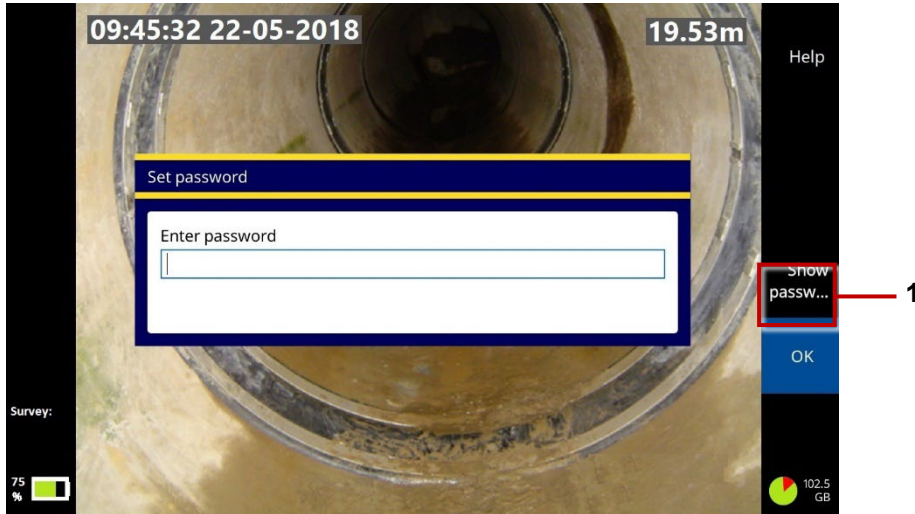
Fig. 5-9: Boîte de dialogue Définir le mot de passe. Cette boîte de dialogue s'affiche lorsque vous vous connectez pour la première fois à un réseau Wi-Fi sécurisé. 1 Bouton Afficher le mot de passe.
