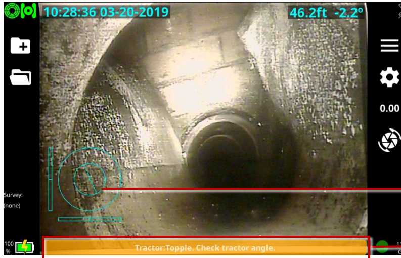
Fig. 6-14 L'avertissement anti-basculement s'affiche au bas de l'écran. Notez que le MIMIC montre aussi un grand angle d'inclinaison.
