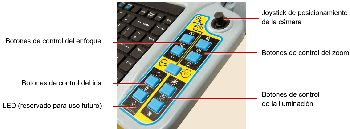
Imagen 6-16 Joystick derecho y botones de control de la cámara e iluminación
