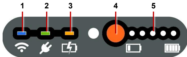
Imagen 3-3: Indicadores de estado en la manija del controlador (vista frontal)
