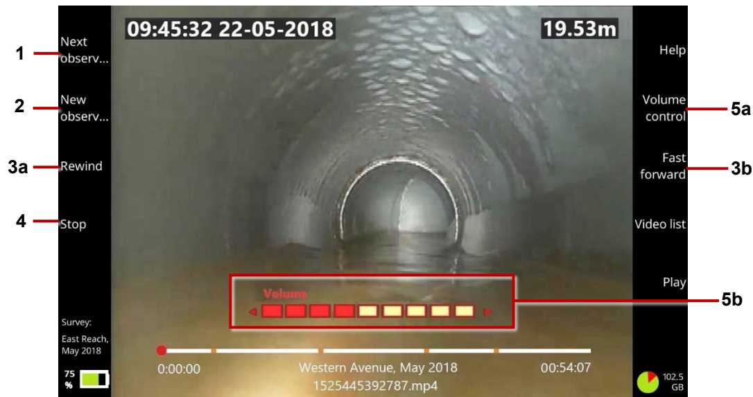
Imagen 6-31: Pantalla de reproducción de video. 1 Botón Siguiente observación. 2 Botón Nueva observación. 3a, 3b Botones Rebobinar y Adelantar. 4 Botón Parar. 5a Botón Control de volumen. 5b Volumen Utilice las ⇐ ⇒ teclas de flecha para ajustar el volumen.
