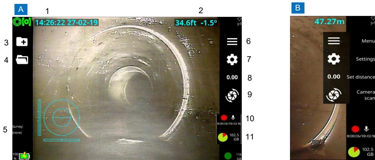
Imagen 3-7: Pantalla de inicio del controlador. A Panel de botones oculto. B Panel de botones a la vista. Consulte la siguiente página para obtener descripciones.
