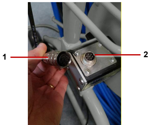
Imagen 4-23: El cable de enlace (1) se conecta al carrete de la varilla de empuje (2)
