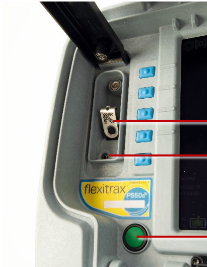
Abb. 4-21: Ein-/Ausschalttaste des Steuergeräts und Anschlüsse an der Vorderseite, mit Headsetbuchse und eingestecktem USB-Speicherstick
