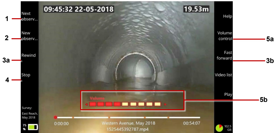
Abb. 6-31: Bildschirm für die Videowiedergabe. 1 Schaltfläche Nächste Beobachtung. 2 Schaltfläche Neue Beobachtung. 3a, 3b Schaltflächen Rücklauf und Schneller Vorlauf. 4 Stop-Taste. 5a Schaltfläche Lautstärkeregelung. 5b Lautstärke Verwenden Sie die ⇐ ⇨ Pfeiltasten, um die Lautstärke einzustellen.
