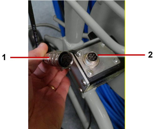
Abb. 4-23: Das Verbindungskabel (1) wird an die Kanalsondenspule (2) angeschlossen.
