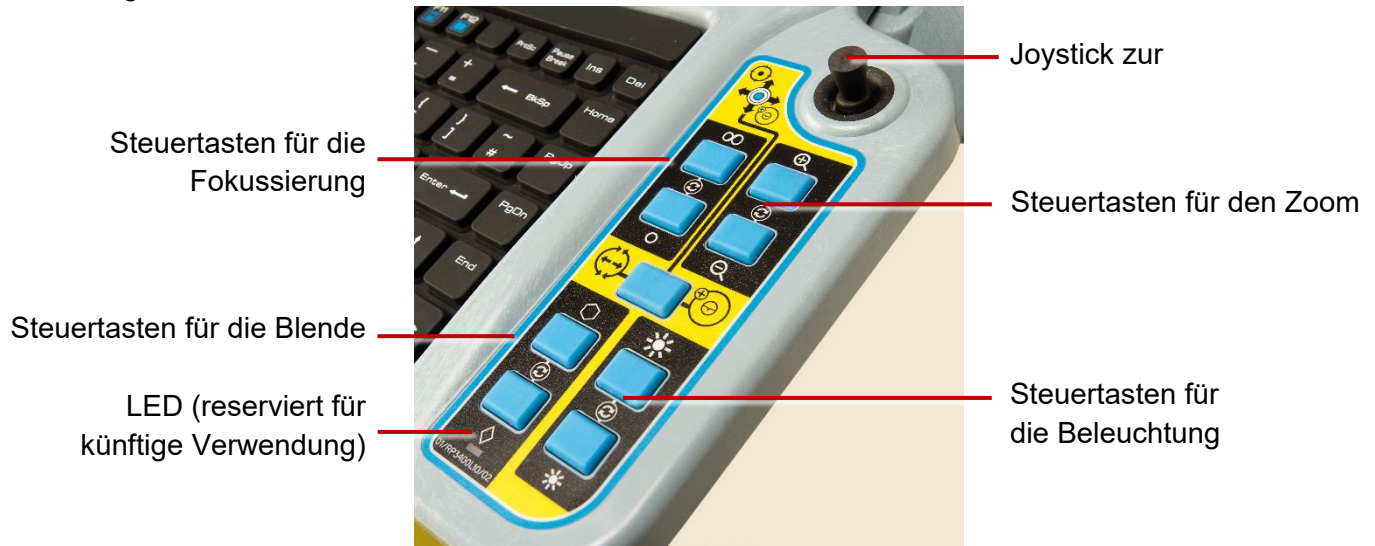
Abb. 6-16 Rechter Joystick und Tasten zur Steuerung von Kamera und Beleuchtung
