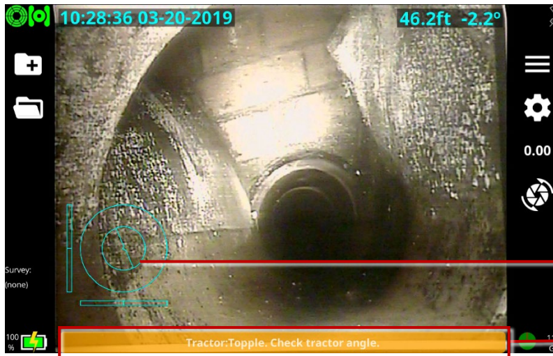
Abb. 6-14 Die Umkippwarnung wird unten auf dem Bildschirm angezeigt. Beachten Sie, dass MIMIC auch einen hohen Kippwinkel anzeigt.
