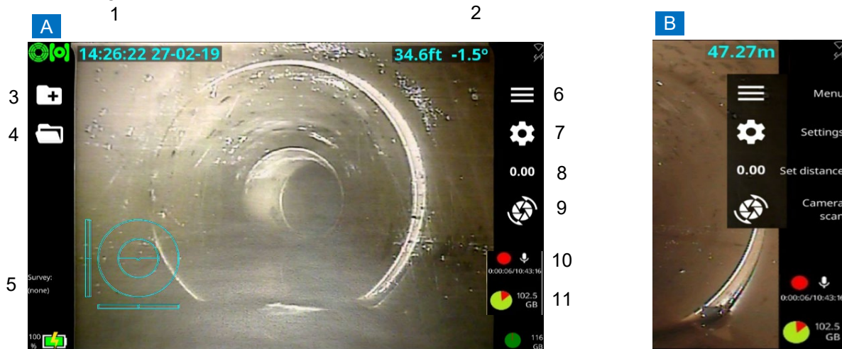
Abb. 3-7: Steuergerät-Startbildschirm A Tastenbeschriftungen ausgeblendet. B Tastenbeschriftungen eingeblendet. Beschreibungen siehe nächste Seite.
