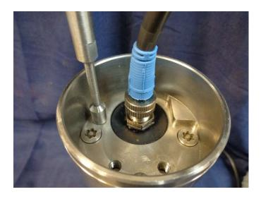
CONNECT BLUE END OF HD356-2 TO THE CAMERA MAKING SURE THE CONNECTOR IS SEATED ALL THE WAY.
