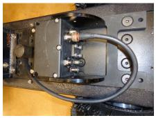
STEP 13- PLUG THE HD347 CABLE TO THE "COAX+6P" CONNECTOR ON THE TRANSMITER BOX.
