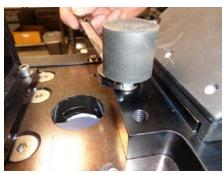
STEP 11- SCREW THE BUMPER ALL THE WAY DOWN AND TIGHTEN THE BUMPER NUT.
