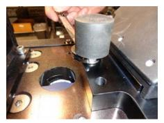
STEP 11- SCREW THE BUMPER ALL THE WAY DOWN AND TIGHTEN THE BUMPER NUT.
