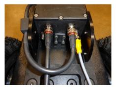
STEP 16- CONNECT THE SONAR CABLE SF342 TO THE "SONAR" CONNECTOR ON THE TRANSMITTER BOX.
