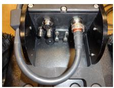
STEP 13- SECURE THE HD342-2 STRAIN RELIEF BLOCK TO THE LEFT WING OF THE TRANSMITTER BOX USING SCREW HW925.
